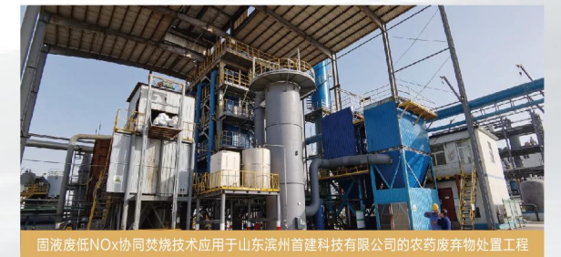
国液超低NOx协同焚烧技术应用于山东滨州首建科技有限公司的农药废弃物处置工程
